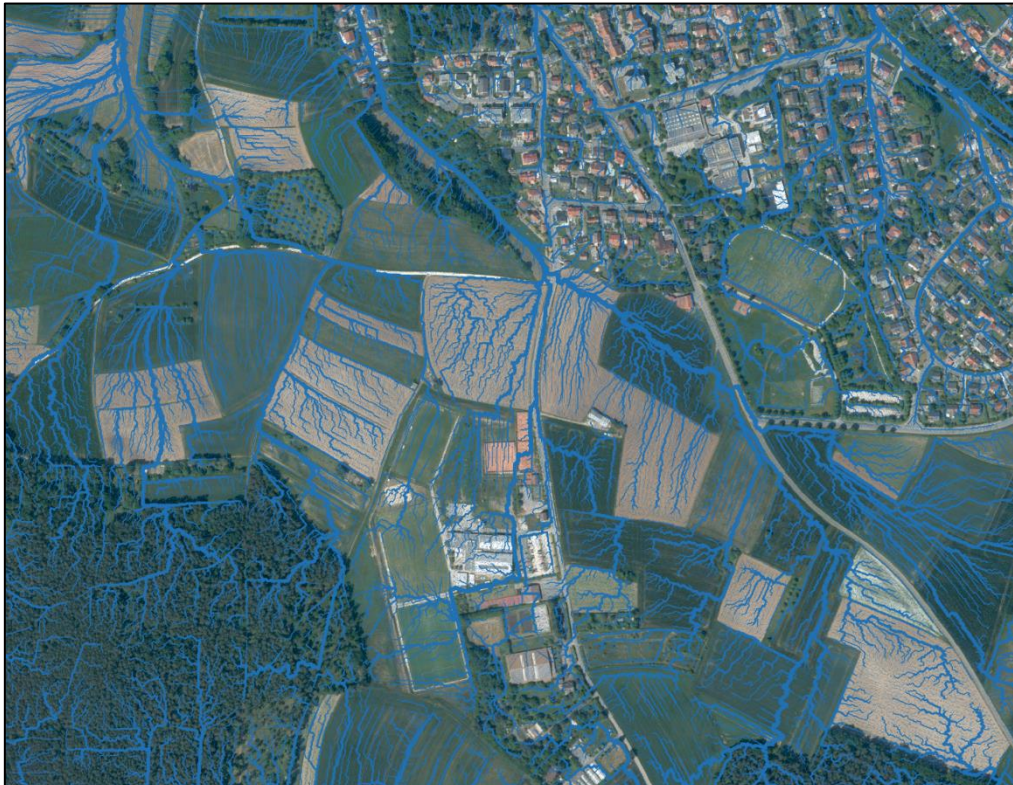
Luftbild ohne Maßstab mit Darstellung der potenziellen Fließwege wild abfließenden Niederschlagswassers (blaue Linienelemente)
