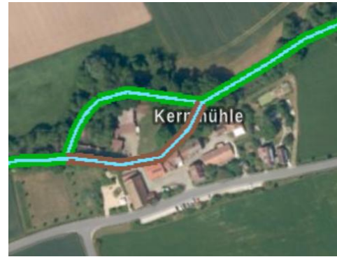
Luftbildauszug der Kernmühle o. M. mit Kennzeichnung bestehender Gewässerrandstreifen. © Luftbild Bay. Vermessungsverwaltung 2025)
